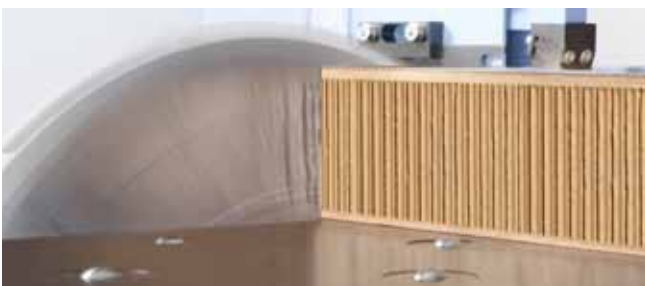
Přířez na formát oboustranným pilovým kotoučem se střídavými zuby (trapézový plochý zub).
