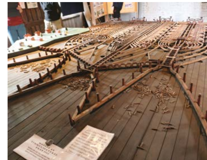
Unikátny model celého systému triedičky splavovanej guľatiny Sandslän ako súčasť múzea Sandslän flottningsmuseum. Model vytvorili pred jej výstavbou v roku 1915, aby sa zistilo, či to celé bude fungovať.
