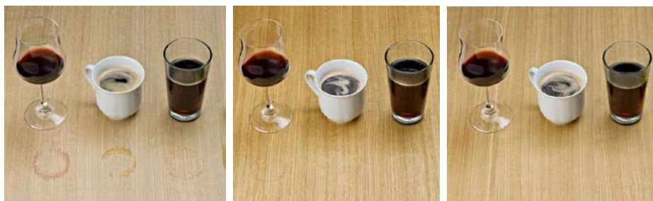
Ukážky reagovania drevených povrchov na tekutiny bežné v kuchyni, pri neurpavenom, olejovanom a lakovanom povrchu, firma Adler
