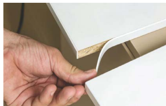
Odlepená hrana s lepidlom EVA
